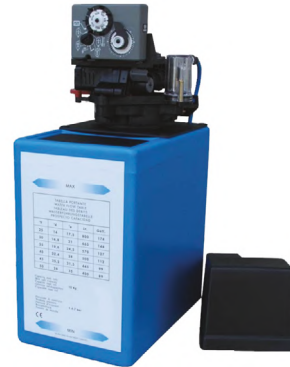
Умягчитель воды с автоматической регенерацией смол благодаря хлориду натрия для потребления более 800 литров
